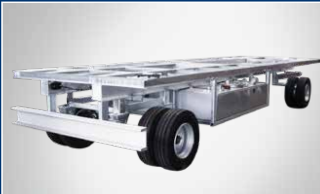
Das Fahrgestell ist verzinkt verfügbar. Natürlich baut man hierzu alle Fahrwerkskomponenten vor der Verzinkung an und wieder ab, damit man keine weiteren Löcher in das verzinkte Fahrgestell bohren muss.
