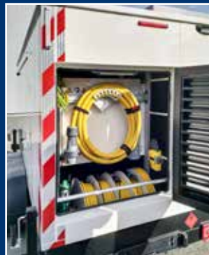
Leistungskabel an Bord, Kabeltrommel mit 24 V Antrieb, Adapterkabel, aufgeräumt.
