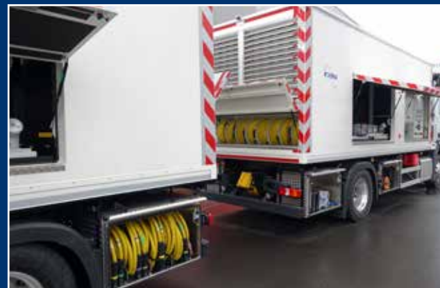
Die Kabeltrommelanlage befindet sich heckseitig unter der Abluft. Verfügbar für bis zu 16 Leitungen 95 mm 2 mit jeweils 25 m.
