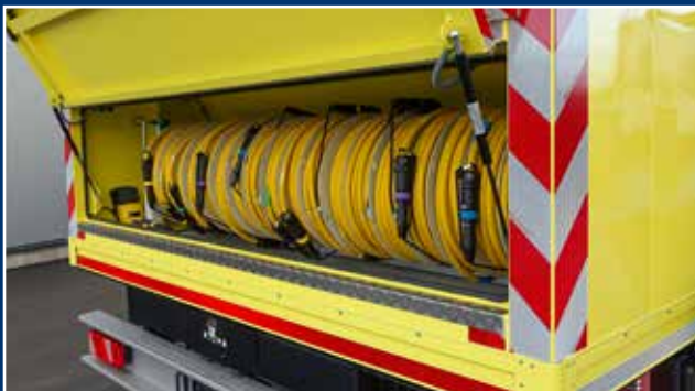
Die Kabeltrommel ist heckseitig angeordnet, sodass das Auf- und Abtrommeln ergonomisch erfolgt.
